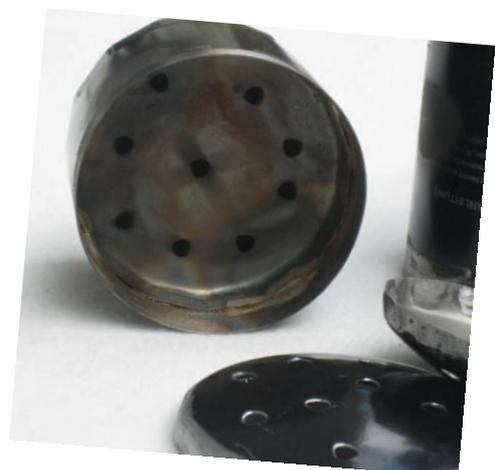
» Die Lötlampe mit einer vollen Gaskartusche betreiben. Halb oder weniger volle Gaskartuschen können bewirken, dass die Lötflamme nicht genug Hitze entwickeln kann. Dickeres Material wird dann nicht mehr rot glühend. In Folge wird das Silberlot nicht mehr zerfließen, sondern nur als klumpige Tropfen am Material kleben. Ich habe da nämlich eine unnötige Erfahrung gemacht.
