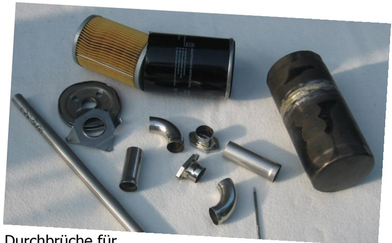
Als nächstes die Positionen der Durchbrüche für die Krümmerrohre auf den Dämpferkörper übertragen und exakt ausarbeiten. Hierbei mit Ruhe und ohne Zeitdruck vorgehen. Der Spalt zwischen Rohr und Dämpfer muss sehr gering bleiben, da das Silberlot nur kurze Distanzen zwischen zwei Bauteilen überbrücken kann!
