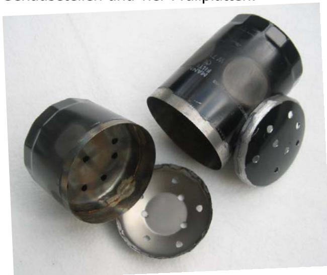
So entsteht ein Dämpfersystem, das je Zylinder eine eigene Einlasskammer mit nachfolgender Zwischenkammer hat.
