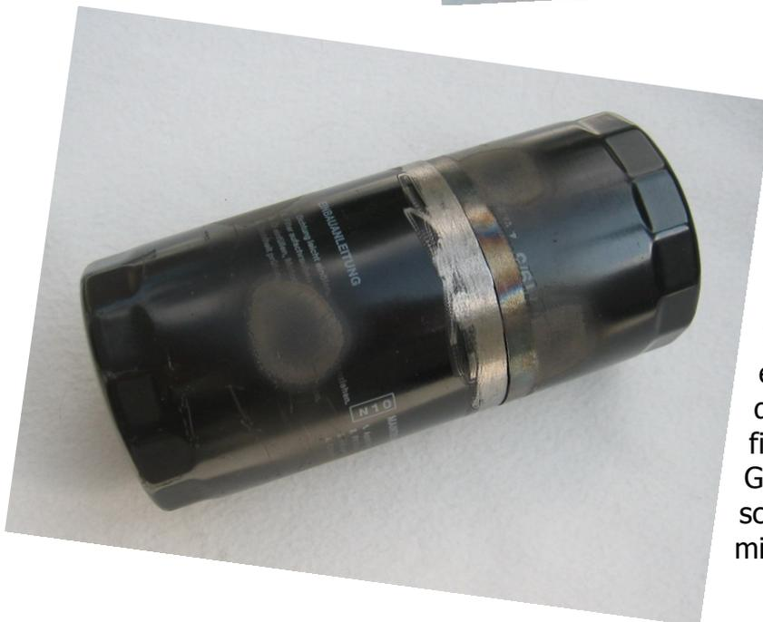
Beide Gehäuseränder werden so von der Prallplatte fixiert – an der Nahtstelle entstehen dann keine Beulen oder Verwerfungen. Zunächst die Prallplatte mit ein paar Lötunkten am Rand der ersten Gehäusehälfte fixieren, dann die zweite Gehäusehälfte darüber schieben und ringsum alles miteinander verlöten.
