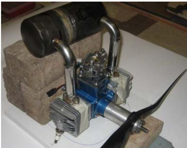
Der Bau des Schalldämpfers endet mit dem Anfertigen und Einlöten des Auslassrohres. Der Durchmesser des Auslassrohres braucht nur 60% dem des Krümmerrohres betragen. Fünfzehn Einlass-Bohrungen mit  $\varnothing$  3mm genügen. (Siehe auch die Skizze des Dämpferaufbaus) Die Länge des Rohres sollte aber maximal wie bautechnisch irgend möglich sein. Je länger, umso weniger Lärm wird es geben!
